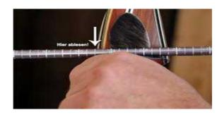
Dann den Pfeil (NICHT SCHIESSEN!) und die Länge von Nockboden bis zur Markierung messen. Nockboden ist die untere Kuhle der Nocke, in der die Sehne einge"nockt" ist. (Siehe das Bild "Pfeil Länge" unten.)
